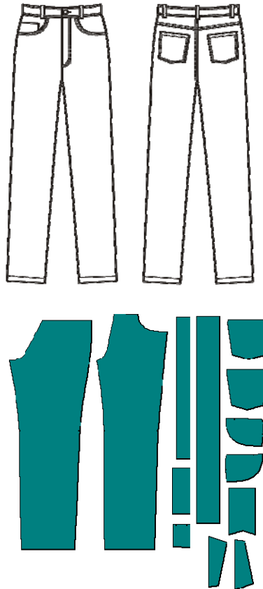
Şekil 1. Seçilmiş ürün modelinin dış görünümü ve TETRA CAD ile tasarlanmış kalıpları
