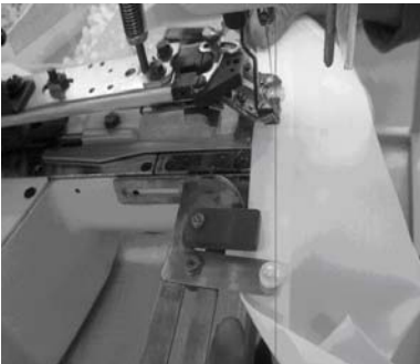
Şekil 15. Ön düğme otomatı ile eski çalışma şekli
