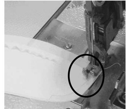
Şekil 21. Baskı ayağı üzerindeki tırnak ile hizalama
