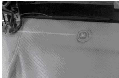
Şekil 17. Yeni çalışma şekli lazer ile doğru hizalama
