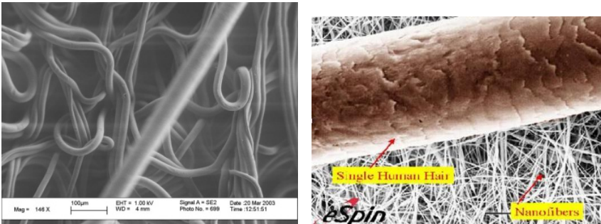
Şekil 8. Nanoliflerin mikroskop altındaki görünümü
