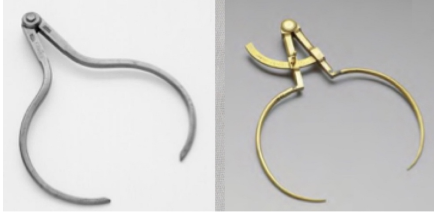
Resim 8a-b. Kaliper Pergel 19.yüzyıl (18,5 cm), Kaliper Pergel 17.yüzyıl (22 cm) (Uzantı 1).
