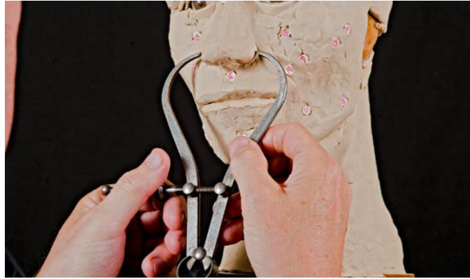
Resim 12. Tıp ve heykel alanında kullanılan vida ile sabitlenen kaliper (Uzantı 4).
