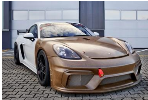
Şekil 7. Doğal elyaf kompozit gövdeye sahip Porsche Cayman 718 GT4 CS MR modeli
