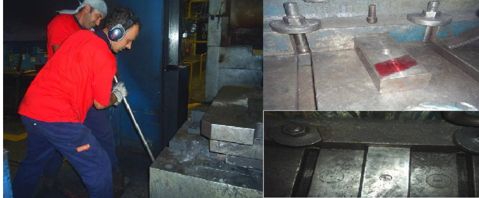
Şekil 5. Kalıp Değişimi ve Dayamalar
