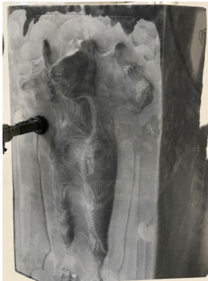
Fig. 17: Afyon. Kerberos heykelinin CNC freze ile hazırlanması çalışmalarının başlangıcı
