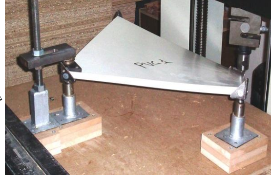
Şekil 4. Panel rijitliği deneyinde yük-yer değiştirme biçimi
