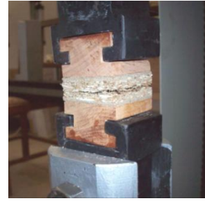
Şekil 3. Levha yüzeyine dik çekme deneyi test düzeneği
