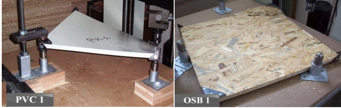
Şekil 11. Rijitlikmodülü deneyleri sonucu meydana gelen göçme tipleri
