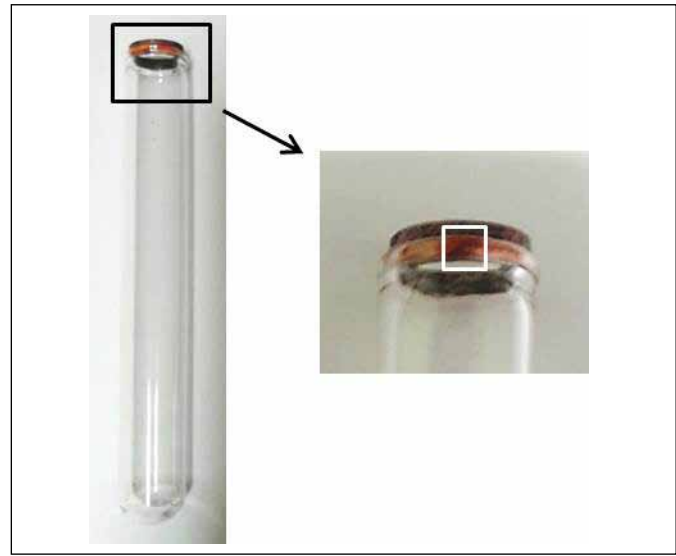
Şekil 1. O 2 /propan alev işlemeyle hava ortamında birleştirilen soda kireç silikat cam tüp – bakır bilezik numunesi ve birleştirme bölgesinin daha yakından alınmış görüntüsü.
