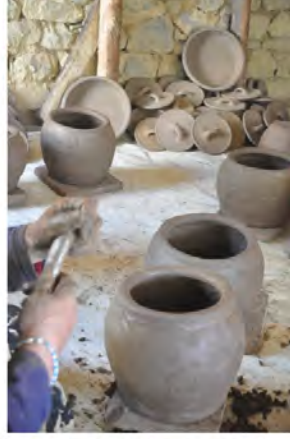
Foto. 16: Çömlek Kulplarının Biçimlendirilmesi.
