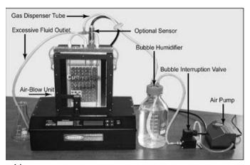
Figure 1. FMT-150 photobioreactor *Şekil 1. FMT-150 tip fotobiyorekatör*
