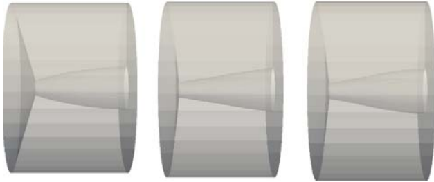
Şekil 6. Burun konik seçenekleri testi: sol Ojiv, orta güç serisi (n=0,5), sol Haack (C=1/3) (Test for nose cone options: left Ogive, middle power series (n=0.5), left Haack (C=1/3))
