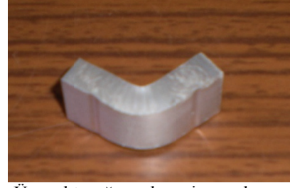
Şekil 6. Üç nokta eğme deneyi uygulanmış Saf Al numune (Pure Al sample applied to transverse rupture strength)
