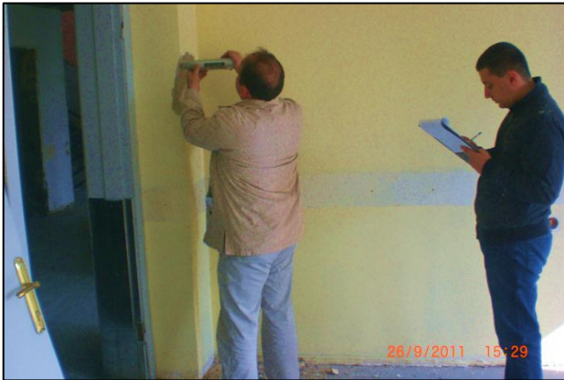
Şekil 3. Yapı yerinde malzeme dayanımının belirlenmesi çalışmaları
