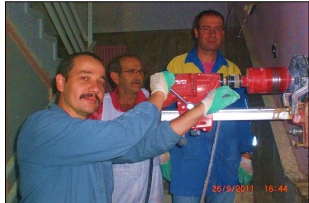
Şekil 3. Yapı yerinde malzeme dayanımının belirlenmesi çalışmaları
