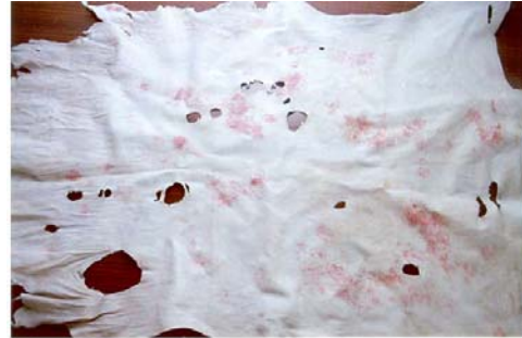
řekil 2- Uzun sre uygunsuz sehpalama ile Penicillium sp. zararına maruz kalmıř kromlu derinin krasttaki grnts (Orj.)
