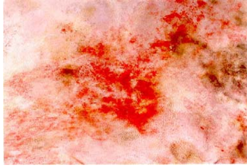
řekil 1.Uzun sre uygunsuz sehpalama ile Penicillium sp. zararına maruz kalmıř kromlu deri (Orj.)
