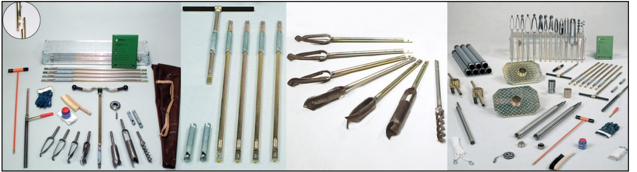
Şekil 1- Eijkelkamp el burgusu sondaj takımı ekipmanı. Figure 1- Eijkelkamp hand (auger) drill equipment.
