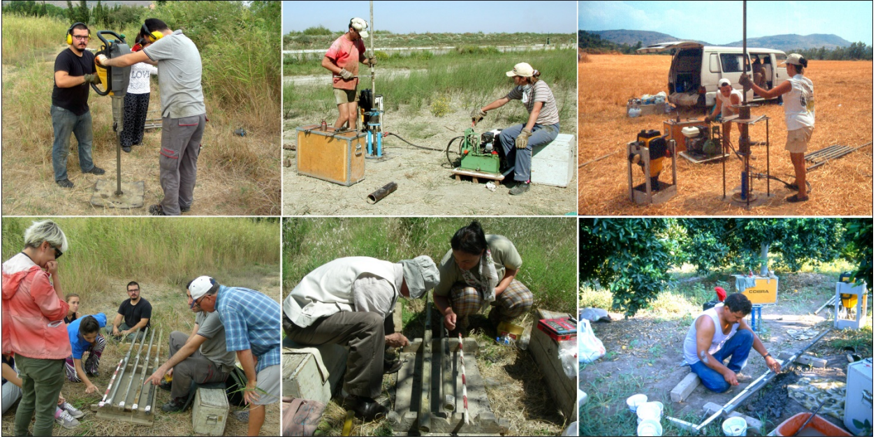
Şekil 3. Sondaj ekipmanı ile çalışma alanlarından belirlenen noktalarda yüzeyden itibaren yeterli derinliğe kadar alüvyon örnekleri alınır, düzenli olarak not edilir, resimlenir ve sistematik olarak torbalanır. Figure 3- Alluvium samples are taken with drilling equipment to the sufficient depth from the surface in defined points in the research area, regularly noted, illustrated and systematically bagged.
