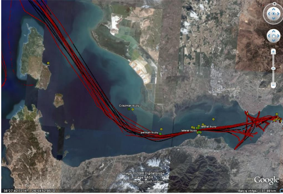
Şekil 2. İzmir Körfezinde 2001–2009 yılları arasında meydana gelen deniz kazalarının AIS verileriyle birlikte gösterimi. (KML verileri renklendirilerek gece ve gündüz Körfez trafiği gösterilmektedir)
