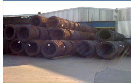
Şekil 1. Sarım şeklindeki metal hammaddelerin açık alanda depolanması
