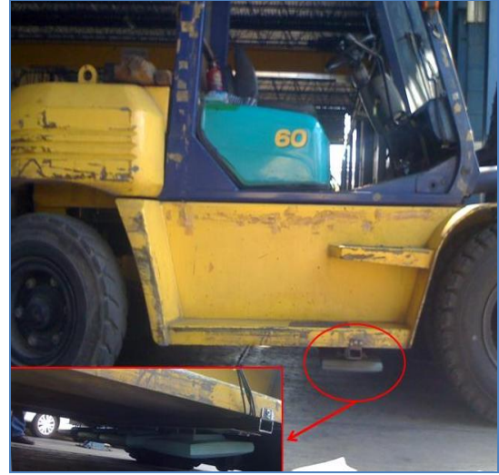
Şekil 3. Forkliftin altına yerleştirilmiş RFID okuyucu
