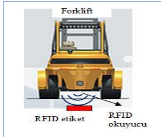
Şekil 5. Zemine gömülü RFID etiketlerin okunması
