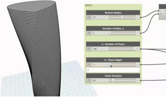
Şekil 2: Dynamo Parametrik Tasarım Modeli
