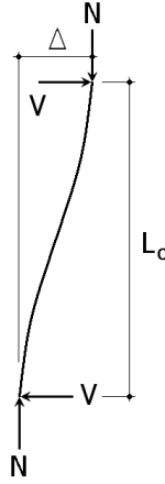
Şekil 5. Kolon şekil değiştirme durumu
