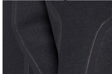
Şekil 18. Ezilmiş neopren kuru dalış kıyafeti [56]
