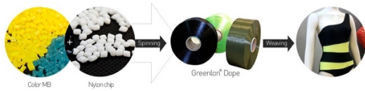
Şekil 3. Greenlon firmasının geri dönüşüm süreci ile mayo elde edilmesi [16]
