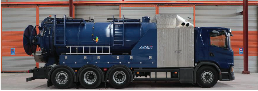
Şekil 1. AKN_VAC 18000 LT kodlu ADR Vakum Tankeri
