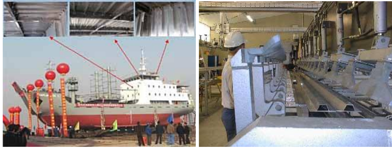
Şekil 10. Sürtünme Karıştırma Kaynağının Gemilerde Uygulanması ve Alüminyum Gemi Panellerini Kaynak İçin Kullanılan Sürtünme Karıştırma Kaynak Makinesi [27]
