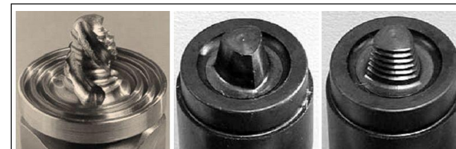
Şekil 7. SKK Yönteminde Kullanılan Farklı Profildeki Kaynak Uçları [16]
