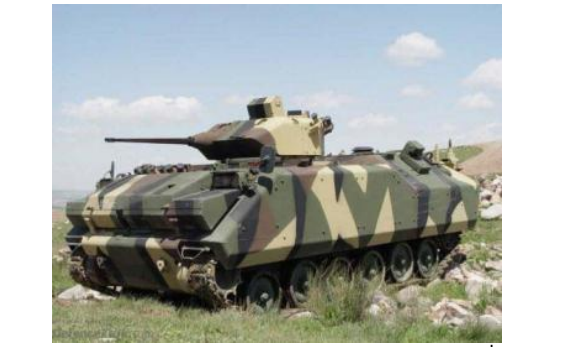
Şekil 16. Sürtünme Karıştırma Kaynağı Yöntemiyle İmal Edilmiş Zirhlı Personel Taşıyıcı [20]
