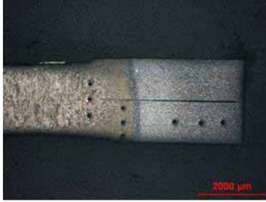
Şekil 6a) Direnç Nokta Kaynaklı Numunenin Mikroyapısı
