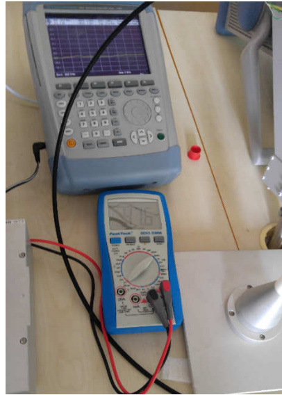
Şekil 10. Önerilen yapı üzerindeki HSMS2860 diyot uçlarının dc voltmetreye bağlanması sonucu ölçülen değer.
