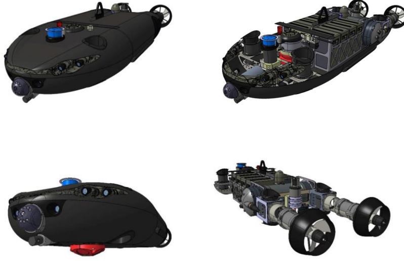
Resim 21.GATE Elektronik tasarımı Askeri Derin deniz keşif AUV si.
