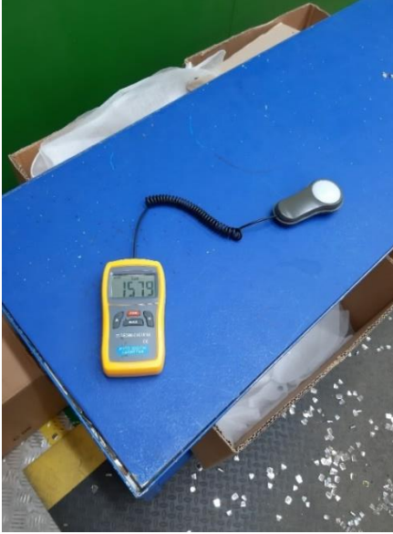
Şekil 4. Çalışma Alanında Aydınlatma Şiddeti Ölçümü
