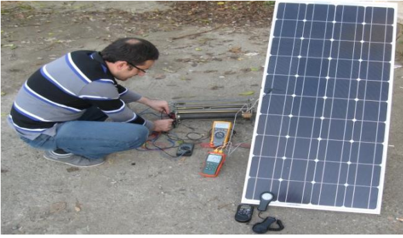
Şekil 15: Kullanılan güneş paneline ait ölçüm düzeneği
