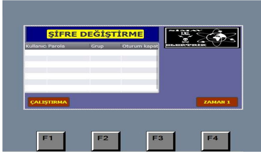
Şekil 8. Operatör Panel Dördüncü Ekran (Şifre Değiştirme Ekranı)
