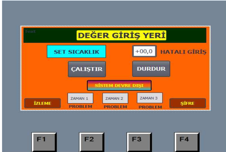
Şekil 7. Operatör Panel Üçüncü Ekran (Değer Giriş Yeri Ekranı)
