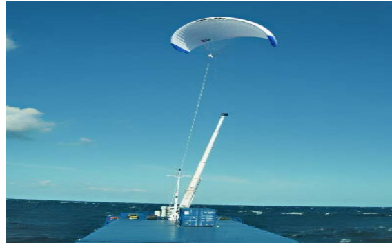
Şekil 7. M/V Theseus "SkySails" sistemi (Brabeck, 2010)
