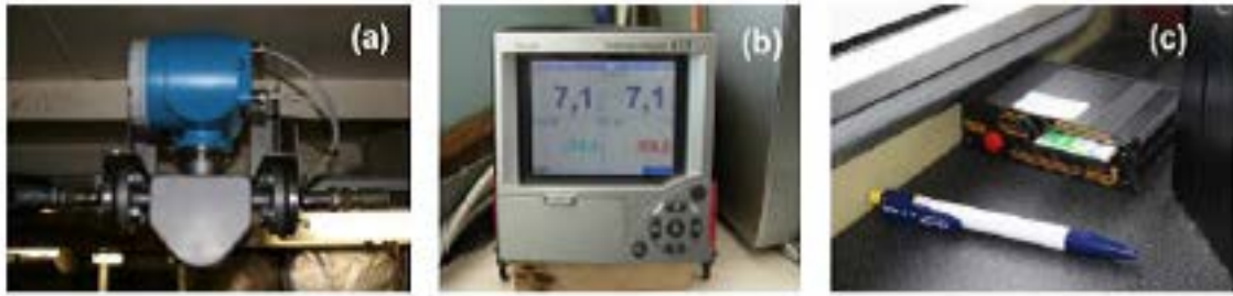
Şekil 2. (a) Yakıt tüketimi ölçümü için kütle akışı sensörleri; (b) Yakıt tüketiminin görselleştirilmesi için geminin köprü üstüne monte edilmiş çok kanallı kaydedici; (c) GPS veri kayıt cihazı (Sala vd., 2010)
