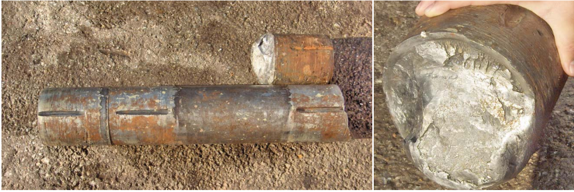
Şekil 2. Kepçe-Kol bağlantı piminin kırılma kesiti.
