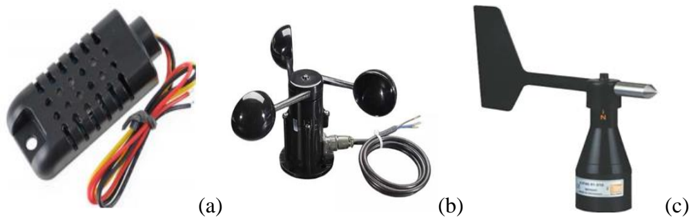
Şekil 2. DHT Isı ve Nem Sensörü (a), QS-FS01 Rüzgâr Hız Sensörü(b) , QS-FX01 Rüzgâr Yön Sensörü
