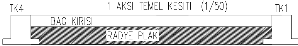
Şekil 8. Temel takviye detayı kesiti
