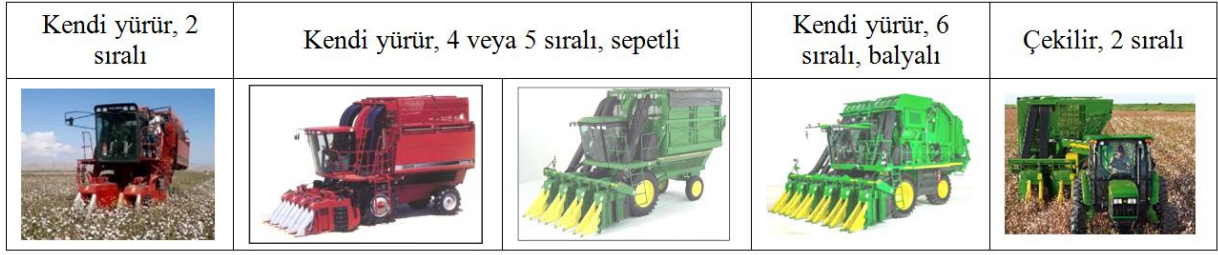
Şekil 3. Türkiye pazarında çalışan iğli sistem pamuk hasat makinaları
