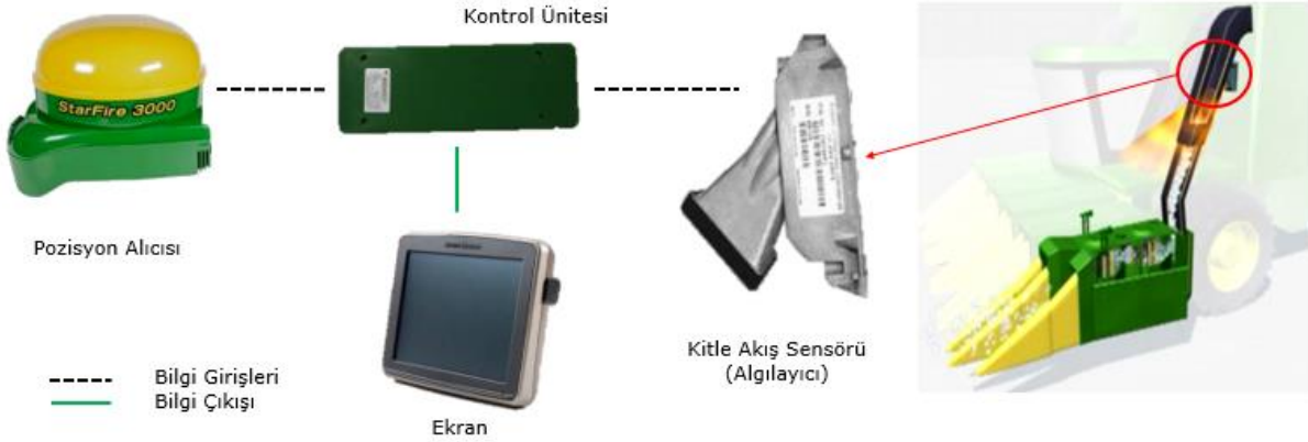
Şekil 9. PHM verim görüntüleme sistemi ve akış şeması
