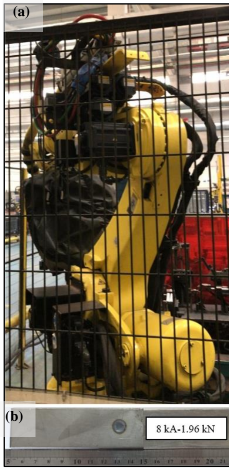
Şekil 1. NDK işlemi deney düzeneği (a) Kaynak robotu, (b) Elde edilen kaynaklı birleşim.
