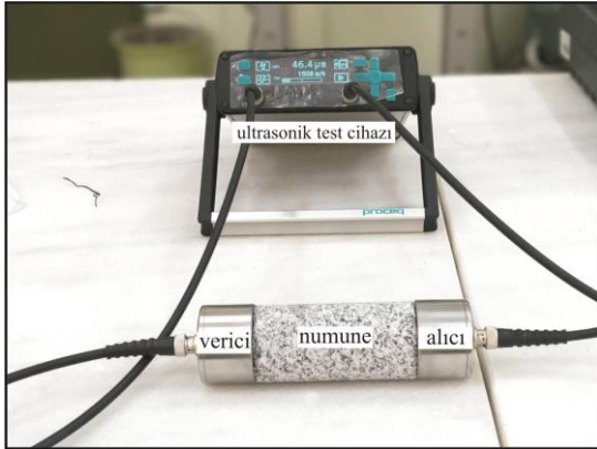
Şekil 4. Kaya malzemesinin ultrasonik test ölçümü
