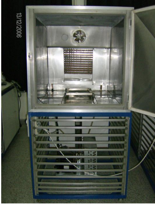
Şekil 1. Havayla ön soğutma sisteminin genel görünüşü
