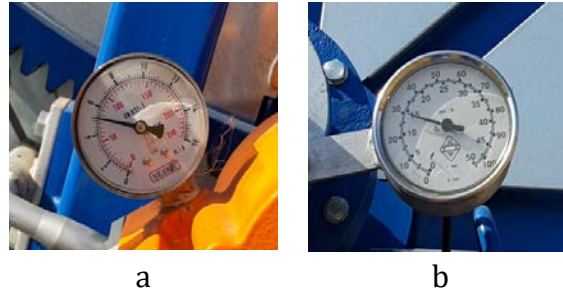
Şekil 6. Manometre (a) ve hız ölçer (b)
