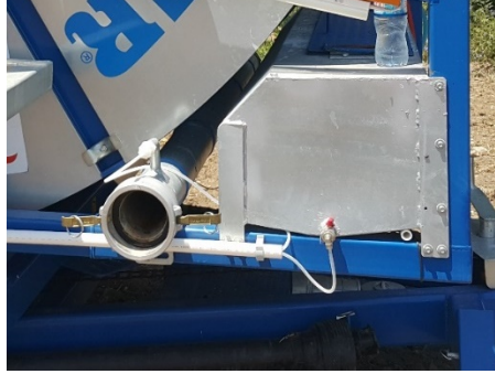
Şekil 3. Emme ve basma hattı ile bağlantı elemanları
