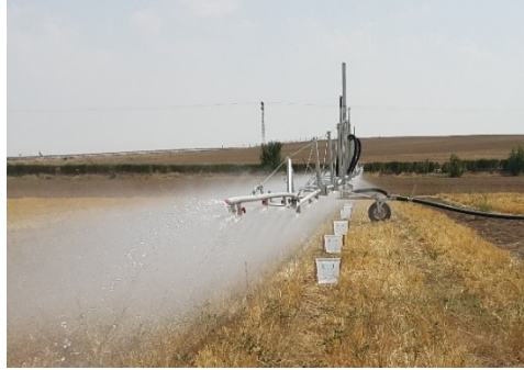
Şekil 11. OTSM su dağıtım düzgünlüğü belirleme çalışmaları
