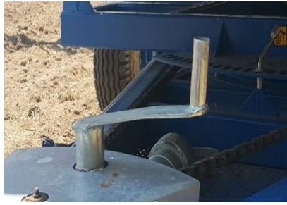
Şekil 9. Tambur gövdesini sağa sola döndürmede kullanılan krank mili
