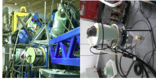
Şekil 1. EXOGAM2 dedektör topluluğunun bir kısmını gösteren fotoğraf (sol) [11]. Testi yapılan bir EXOGAM2 dedektör fotoğrafı (sağ)
