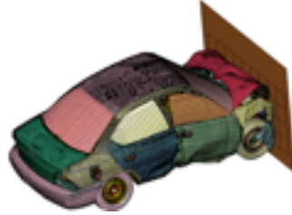
Şekil. Araçlarda önden çarpışma analizi sonuçları / Figure. Result of the frontal crash analysis in the vehicles
