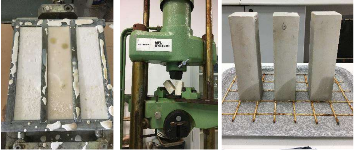
Resim 3: Solda; M malzemesinin kalıptan çıkarılması, Ortada; T malzemesinin eğilme dayanım düzeneği, Sağda; C malzemesinin kılcal su emme düzeneği
