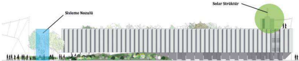
Şekil 7. Pavilyon görünüşü üzerinden sisleme nozulü ve solar strüktür kullanımı (URL – 2)
