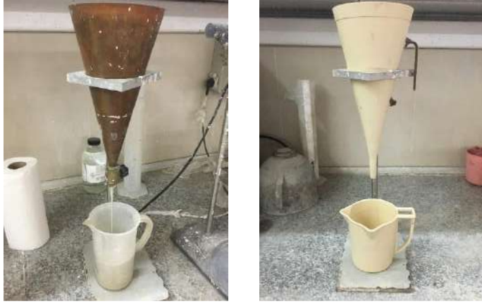
Resim 1: Akış Konisi ve Marsh Hunisi
