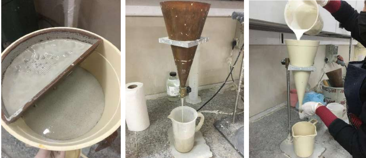
Resim 5: Akışkanlık özelliğinin belirlenmesi sırasıyla C, T, M
