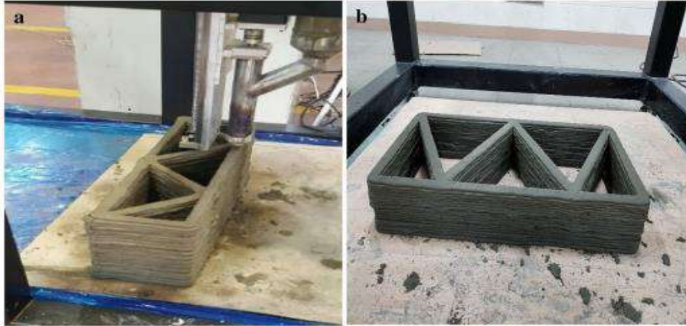
Şekil 7: 3D yazıcıyı kullanarak içi boş bir beton duvarın basılması (Jo, Jo, Cho, & Kim, 2020)
