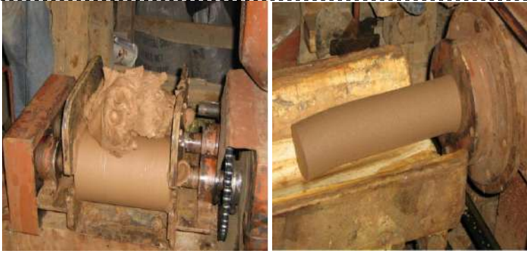
Şekil 3 ve 4: Çamur makinesinde işlenen kilin hamur makinasında yoğurulması ve işlenmeye hazır hale getirilmesi. Didem Baran Ergül 2021
