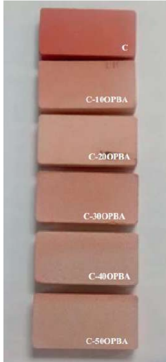
Şekil 5. Killi Tuğla (en üstte-C) ve Ağırlıkça %10-50 Oranında Pirina Külü İçeren Tuğla Numuneleri (Jose ve Castro, 2015)
