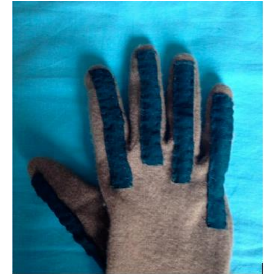
Şekil 4. Eldiven Tasarımı ve Flex Algılayıcılar için cepler
