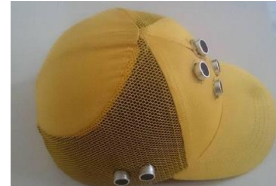
Şekil 5. Geliştirilen ultrasonik sensörlü şapkanın yandan görünüşü
