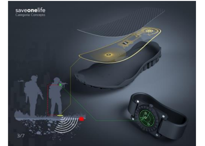
Şekil 12. SaveOneLife giyilebilir mayın detektörü
