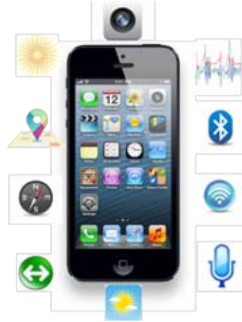
Şekil 1: Standart bir iPhone ve içine gömülü sensörler: jiroskop, dijital pusula, ivmeölçer, yakınlık sensörü, ortam ışığı sensörü, sıcaklık sensörü, mikrofon, GPS, WiFi ve Bluetooth sensörü.
