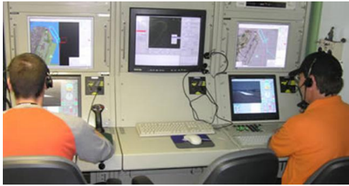
Şekil 4- Raytheon Firması Sanal Kokpit Sistemi
