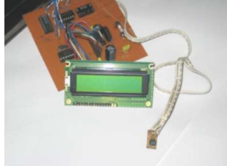
Şekil 4. Hazırlanan sıcaklık-nemölçerin görüntüsü.
