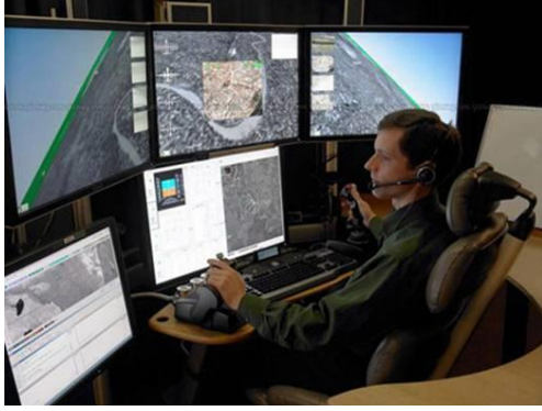
Şekil 3- Heron Uzaktan Kontrol Sanal Kokpit Sistemi (İsrail)
