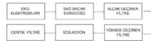
Şekil 2.2 Giyilebilir EKG blok diyagramı
