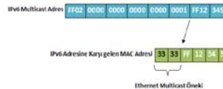
Şekil 3. IPv6 Multicast MAC Adresi
