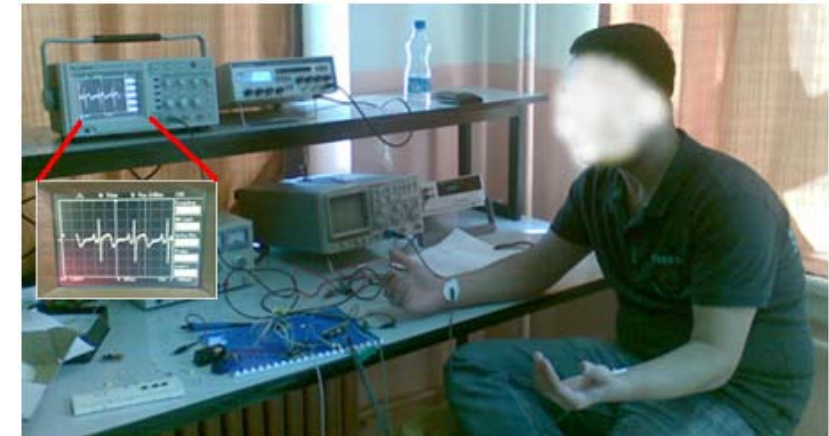
Şekil 4. Prototip EKG devresinin test edilmesi
