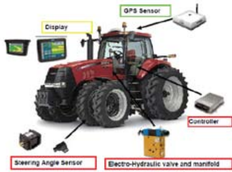
Şekil 7. Oto-pilot sisteminin temel elemanları (Trimble, 2005).
