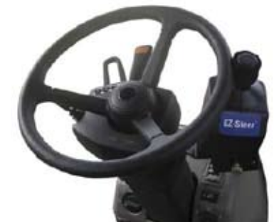
Şekil 6. Elektrik motoru ile direksiyon kontrolü (Trimble, 2005).
