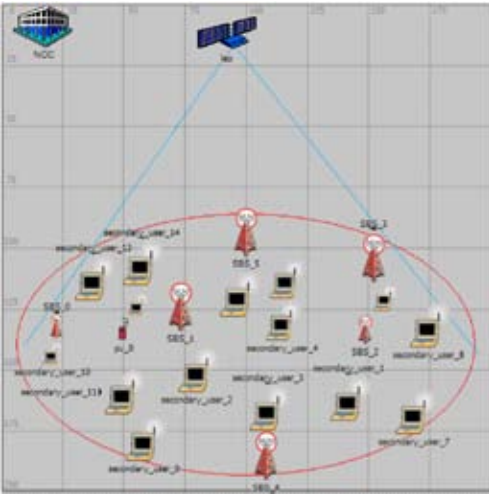
Şekil 5. OPNET simüle edilen örnek ağ yapısı.
