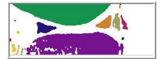
Şekil 3c. OTSU Eşikleme ve Görüntü Açma yöntemlerinin uygulanması. (Eşik değeri: 124)
