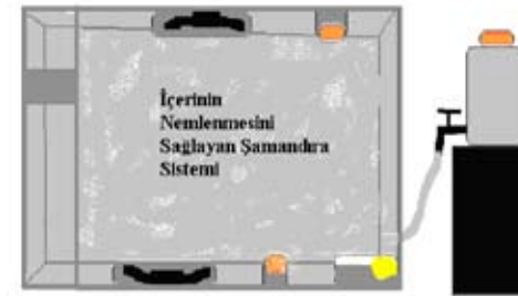
Şekil 3. Kuluçka Makinesinde Kullanılan Nem Düzeneci
