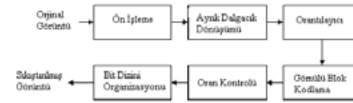
Şekil 2. JPEG2000'in kodlama aşamaları
