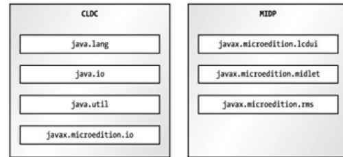
Şekil 2. MIDP API'yi oluşturan paketler
