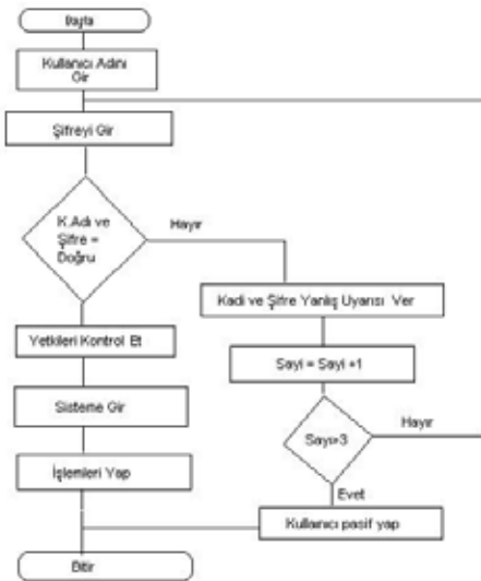
Şekil 4: Kullanıcı Sınama Akış Diyagramı.
